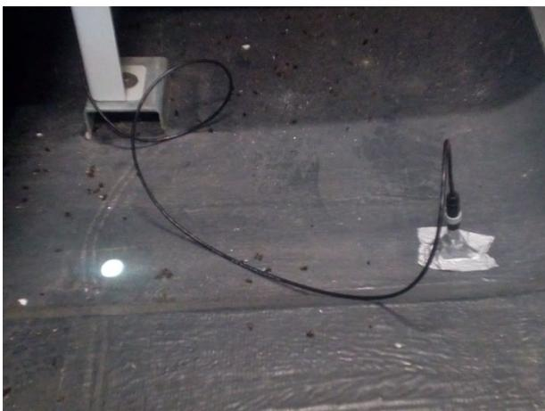
Photo 2 : Micro installé dans un trou de la coque de la nacelle sous le plancher
